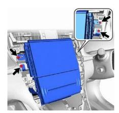
ナビの左右各2本のボルトを外し、モニター部分と エアコンスイッチパネルを一緒に引き出して、別紙 2箇所のコネクタに、本製品のハーネスを割り込ま せます。
