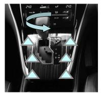
シフトノブを矢印向きに回して外します。 シフトパネルの6箇所のクリップ、コネクタ類を外し、パネルを外します。
