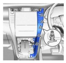
ラジオパネルの左右各5箇所のクリップ、 コネクタ類を外し、パネルを外します。 (反対側も同じ要領で外します)
